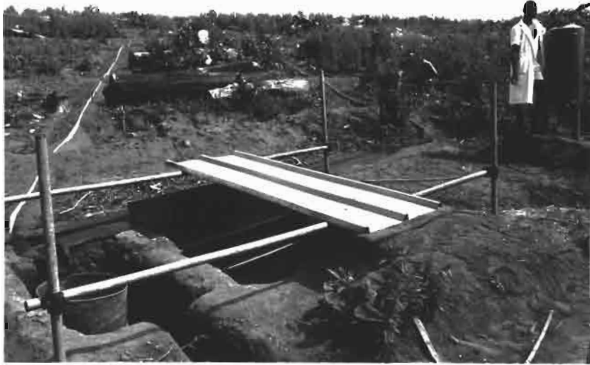
Fig. 4 - Vue générale de la case d'érosion et de lessivage oblique (photo DUVAL) ANGUEDEDOU - Sables tertiaires - plantation d'hévéas en novembre 1965 en courbe de niveau après l'abat-tage de la forêt.
