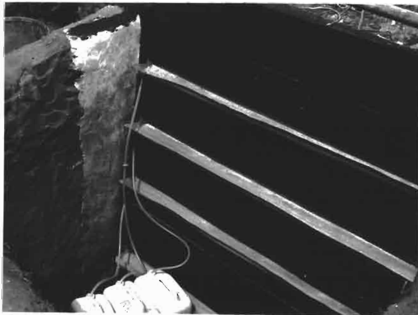
Fig. 5 - Détail de la case d'érosion et de lessivage oblique : les gouttières "g" reliées aux jerrycans par des tuyaux en plastique ; le canal "c" du ruissellement débouche directement dans un fût de 200 litres ; le toit a été enlevé pour la photo novembre 1967. (photo DUVAL).
