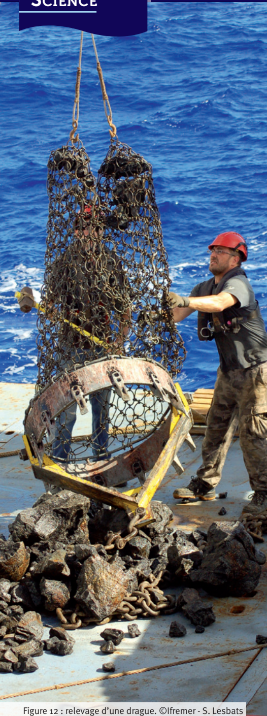
Figure 12 : relevage d'une drague. ©Ifremer - S. Lesbats
