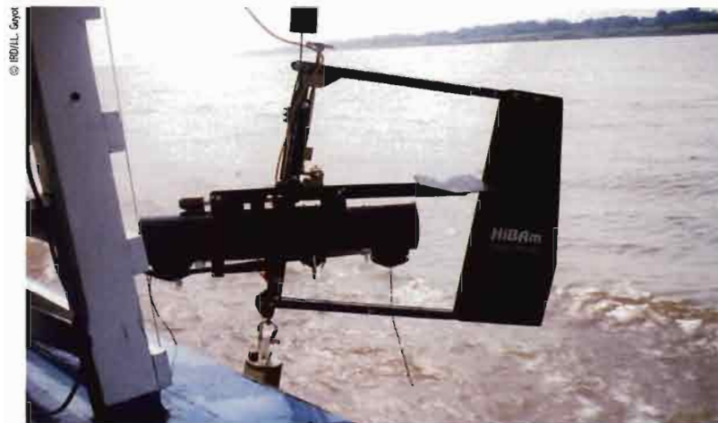
Vue de l'échantillonneur CLD-2 pour le prélèvement d'eau et de matières en suspension.
