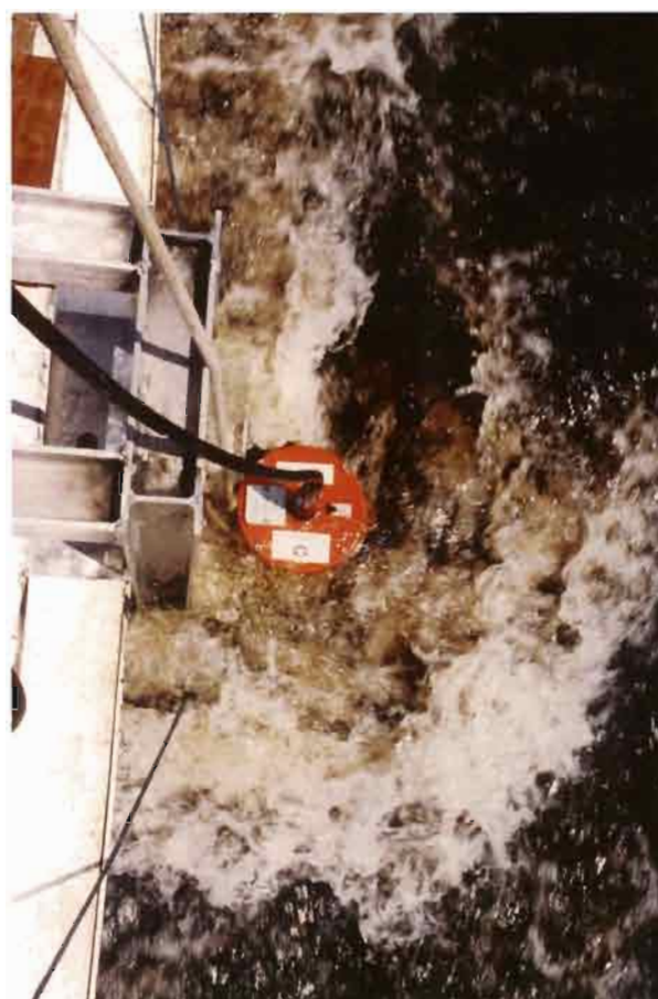
Equipement ADCP pour jaugeage par effet Doppler, Rio Negro.
