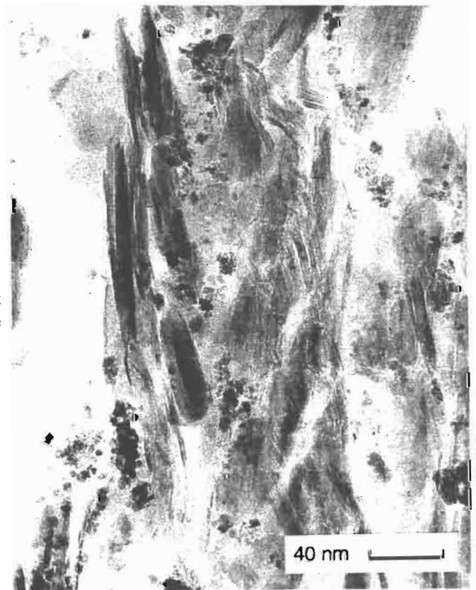
Photo 4 : Cristallites de kaolinite flexueux, dont l'organisation par raccordement tangential, ménage un volume de vide important (P1.1).
