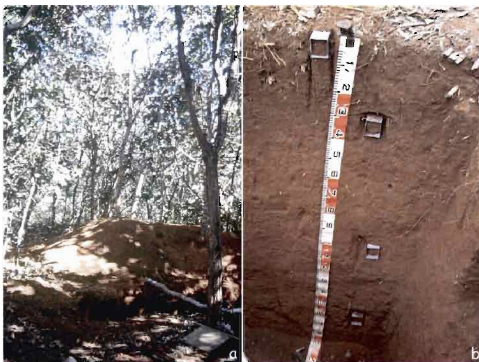
Figure 13 : Ferralsol localisé sous Cerradão en milieu de pente (profil CER 2) : a) fosse pédologique et son environnement, b) face échantillonnée avec localisation des prélèvements pour étude en microscopie.
