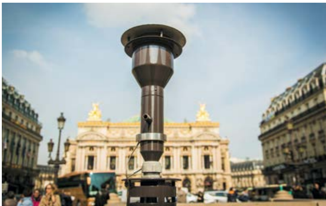
Capteur de pollution d'Airparif pour le contrôle de la qualité de l'air à Paris
