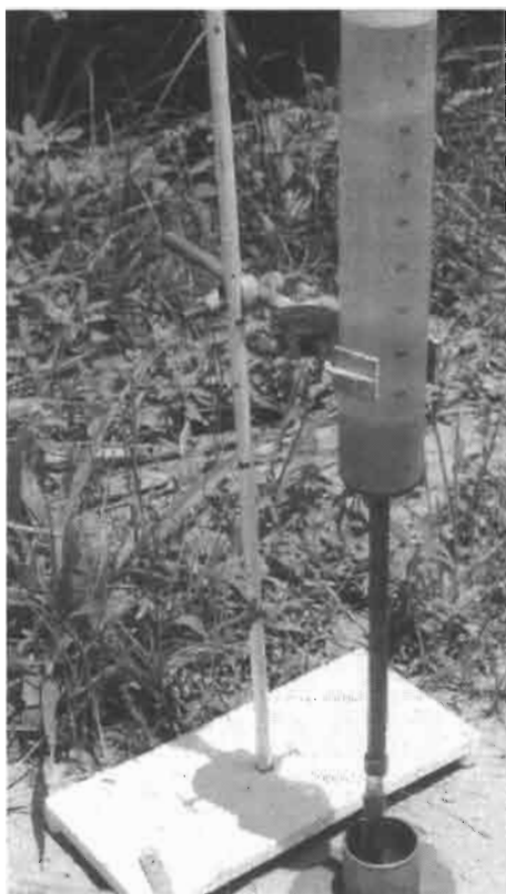
FIGURE 3.18 – Dispositif expérimental pour la mesure du flux d'infiltration maximal dans un orifice de galerie.
