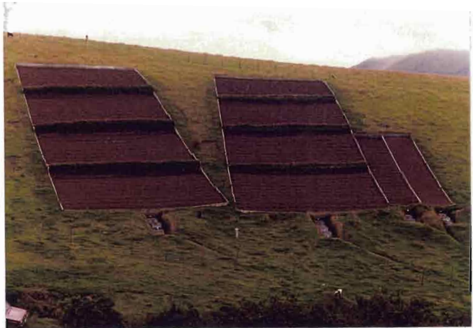
Site expérimental de Mojanda. Les deux plus grandes parcelles ont 1000 m 2 de surface. Sur celle de gauche, ont été installées des murets de mottes d'herbe, retournées et empilées ; sur celle de droite, ont été testées des bandes enherbées associées à des murets de mottes d'herbe. Ces ouvrages, dérivés des pratiques locales, évoluent vers des terrasses de construction progressive.
