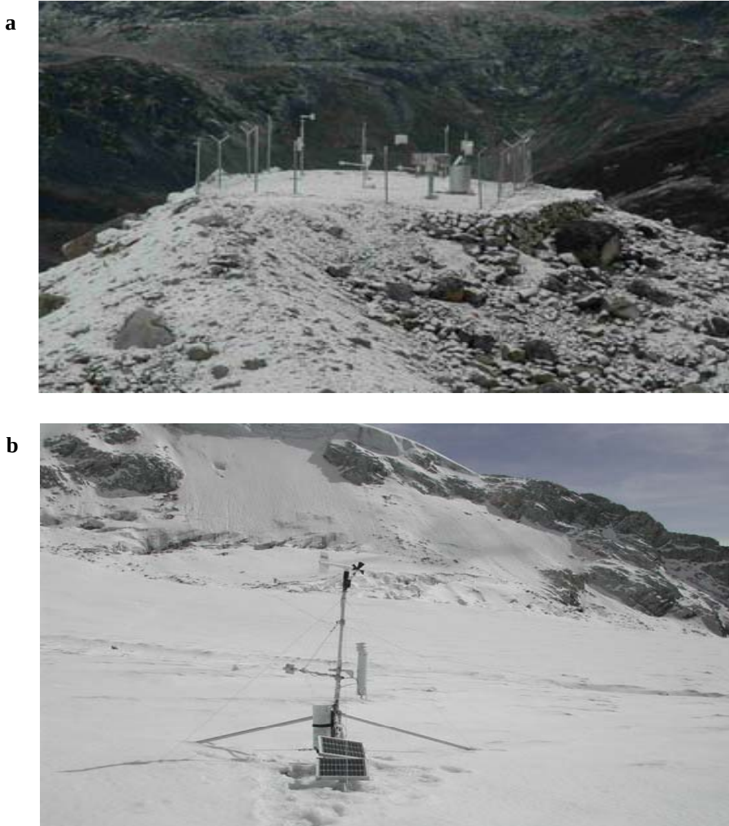
Figure 2.1. Stations automatiques de mesures météorologiques de surface du haut bassin versant du Zongo, a) station "moraine" AWS-ORE-Zongo de l'ORE GLACIOCLIM (5050 m), b) station "glacier" AWS-GLA-Zongo (5050 m).
