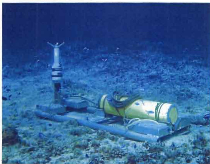
Figure 3 : Photographie du courantomètre ADV fixé au fond.
