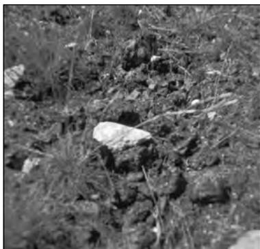
Échantillon 1 : **0,06 % Ni** ; 0,0 % Co ; 33,4 % Fe<sub>2</sub>O<sub>3</sub> ; 3,5 % MgO ; 48,2 % SiO<sub>2</sub> ; 0,03 % Cr<sub>2</sub>O<sub>3</sub> ; 9,7 % Al<sub>2</sub>O<sub>3</sub> ; 0,13 % Mn ; 8,0 % CaO ; **2,75 % Cu** ; 0,5 % Na ; 1,4 % K ; 0,13 % Zn.
