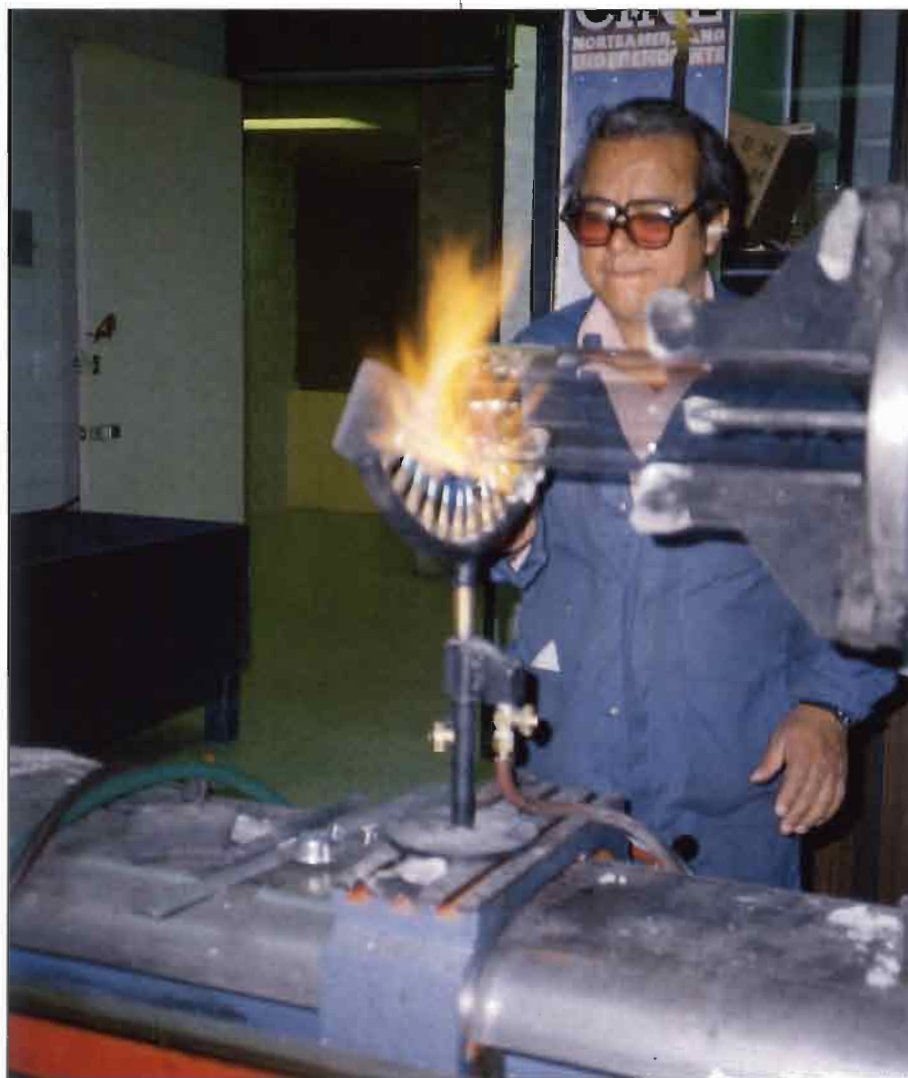
Fabrication des cuves de fermenteur à l'atelier de verre de la UAM-I - Photo : S. Roussos
