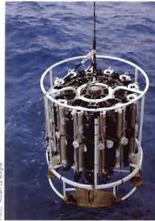
Rosette à prélèvement d'eau à différentes profondeurs.
