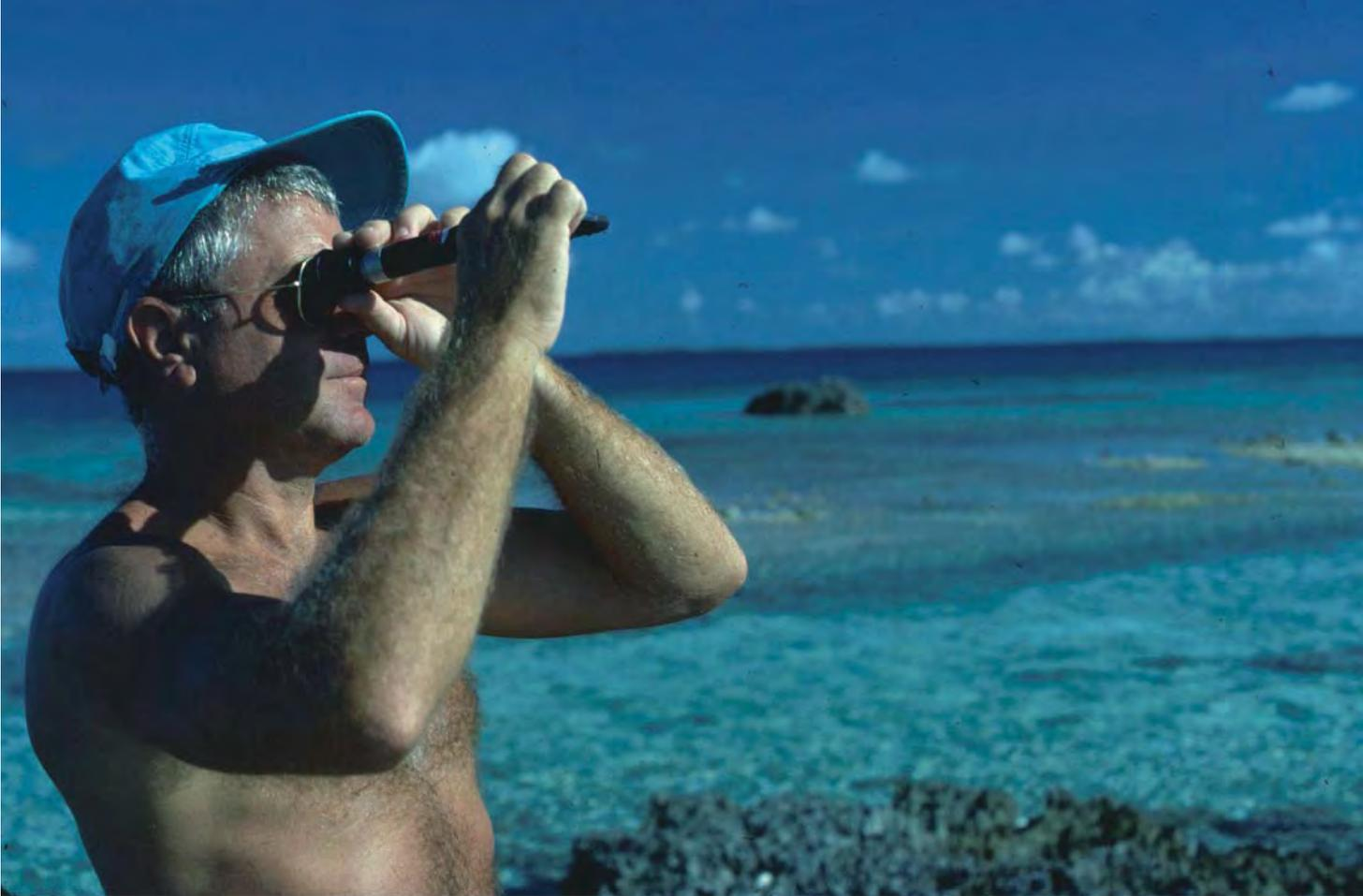
Mesure de la salinité de prélèvement d'eau par réfractomètre. © J. Orempuller
