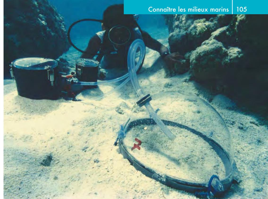
Structure de mesure des échanges du substrat.
