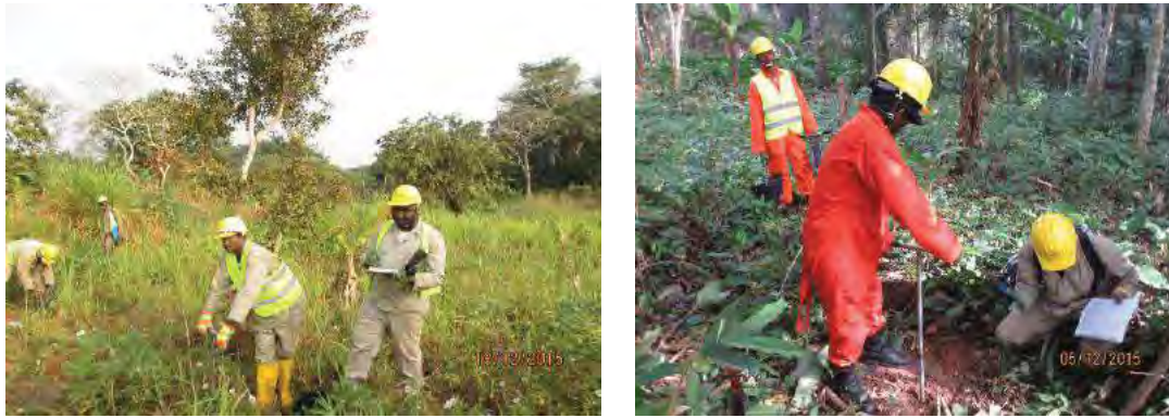
Photo 2 : Tarières manuelles sur l'aire des entreprises/carrière
