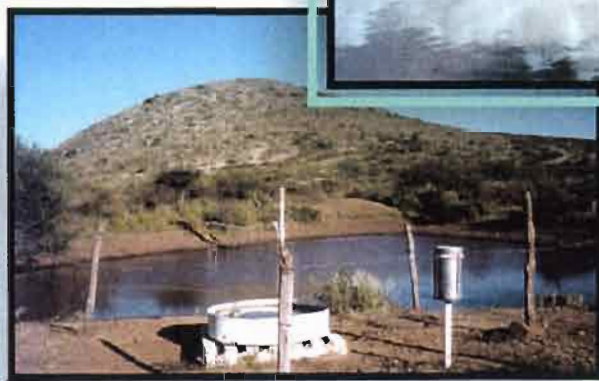
Le presón Carboneras, pluviomètre et bac classe A
