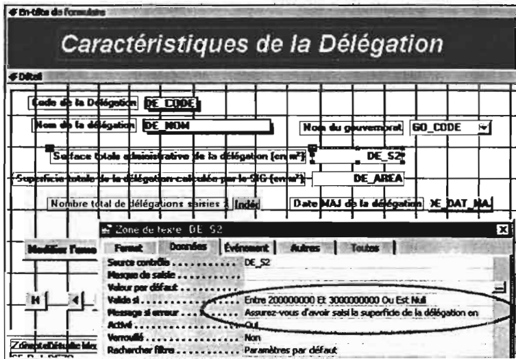
Figure 46 : Définition de seuils de validité et d'un message d'erreur en cas de dépassement des seuils de validité sur contrôle
