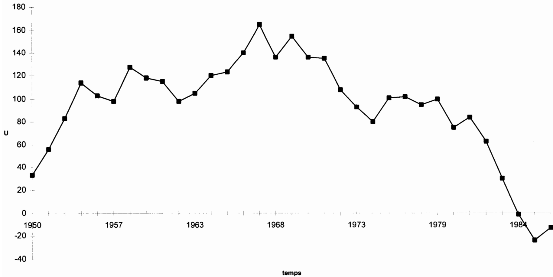
Evolution de la variable U du Test de Pettitt Cumul des hauteurs de pluie sur la periode du mois de Janvier au mois de D_cembre - 1380019900 NIORO DU RIP
