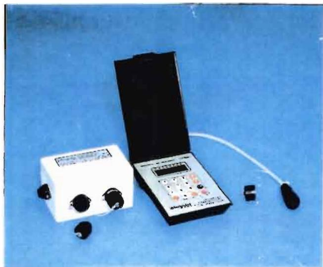
*PLUVIO 89 est un enregistreur autonome destiné à être connecté à un pluviomètre à augets basculeurs équipé d'un contacteur.*
