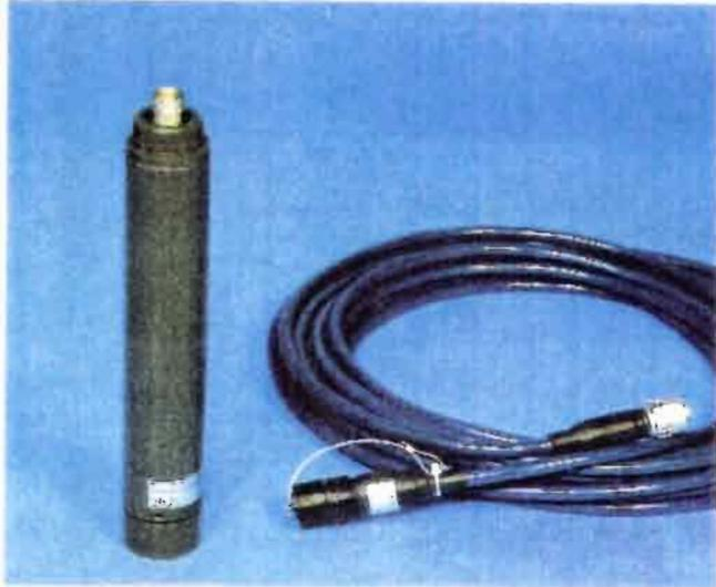
Développée en collaboration avec le service hydrologique de l'ORSTOM(\*), le SPI III est un ensemble électronique et informatique destiné à la mesure précise des niveaux et températures des liquides de densité constante.
