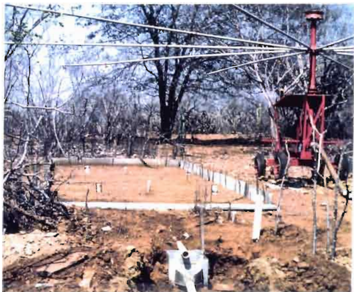
Simulateur de pluie type "swanson" sur le bassin du Riacho do Navio
