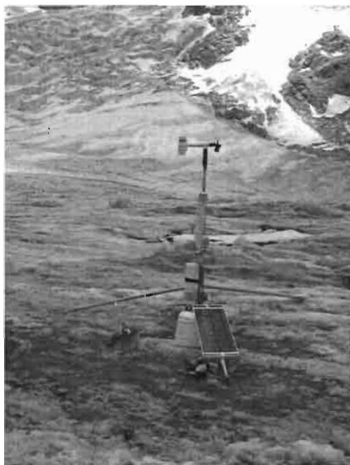
Figura 3.8. Estación meteorológica SAMA localizada sobre el glaciar a 5050 msnm.
