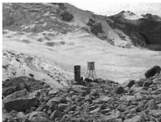
Figura 3.10. Sensor HOBO contenida en la caseta blanca (junto al pluviómetro totalizador P1) localizada sobre la morrena lateral derecha del glaciar a 5150 msnm.
