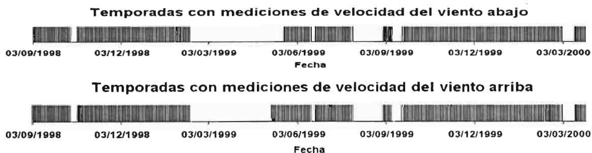
Gráfico 6.17.: Temporadas con mediciones de velocidad del viento a los 30 cm y 180 cm del suelo.
