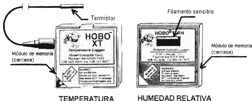
Figura 4.1.: Designación de las partes principales en los sensores (HOBO) utilizados a 4750 m.s.n.m.
