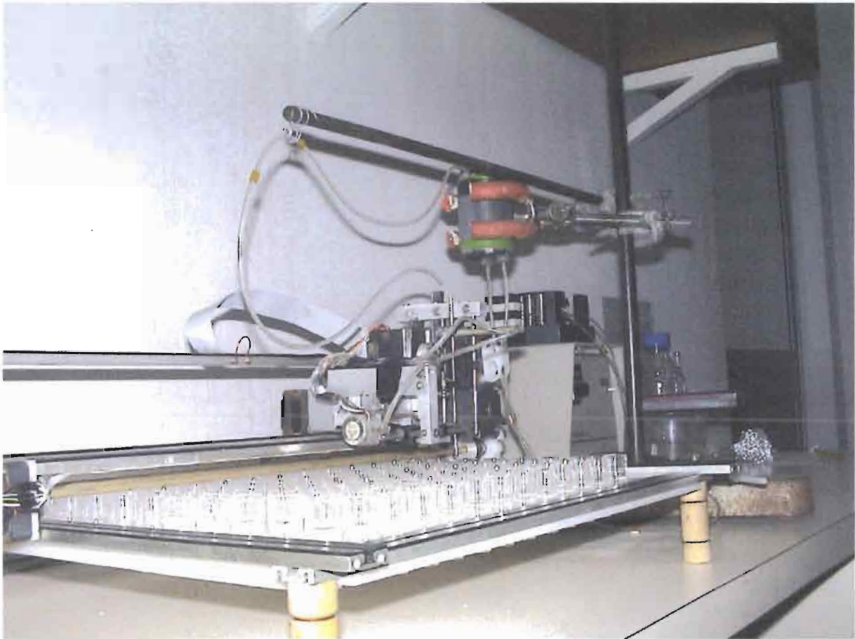
Figure 4: dispositif de traçage et de collecte des fractions de solution pour établir la courbe d'élution
