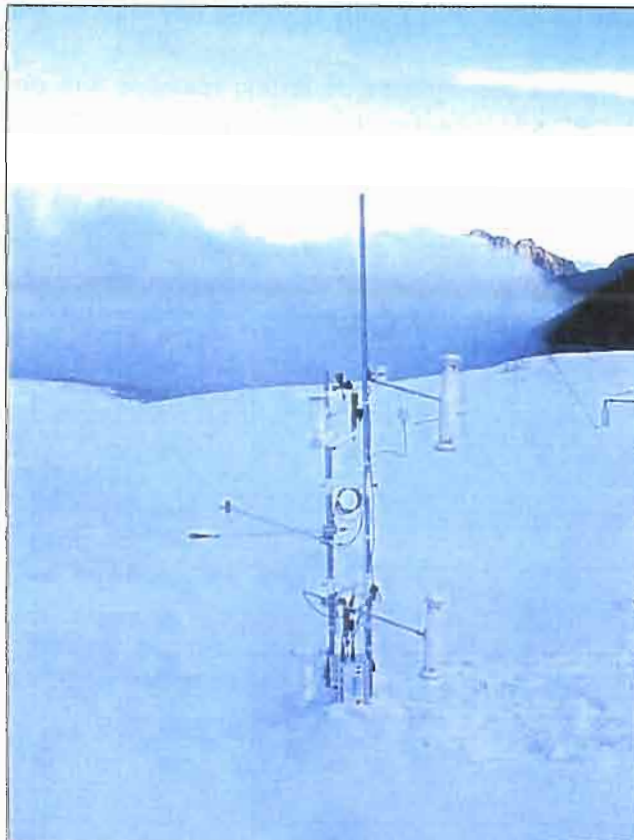
Figure 7 : Station météorologique automatique sur le glacier du Zongo (5150 m). On aperçoit au front du glacier des nuages redescendant dans la vallée du Zongo. 12/12/99, 18h00. (Photo : Leblanc J.M).
