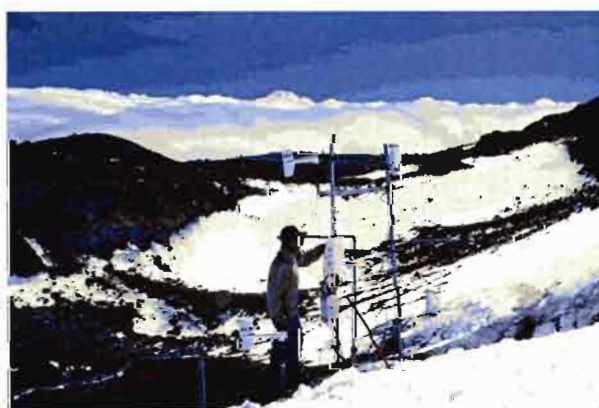
Figure 9 - Mesure de l'équilibre énergétique à 4900 m sur le glacier 15 \alpha (Photo: B. Francou, 1999)
