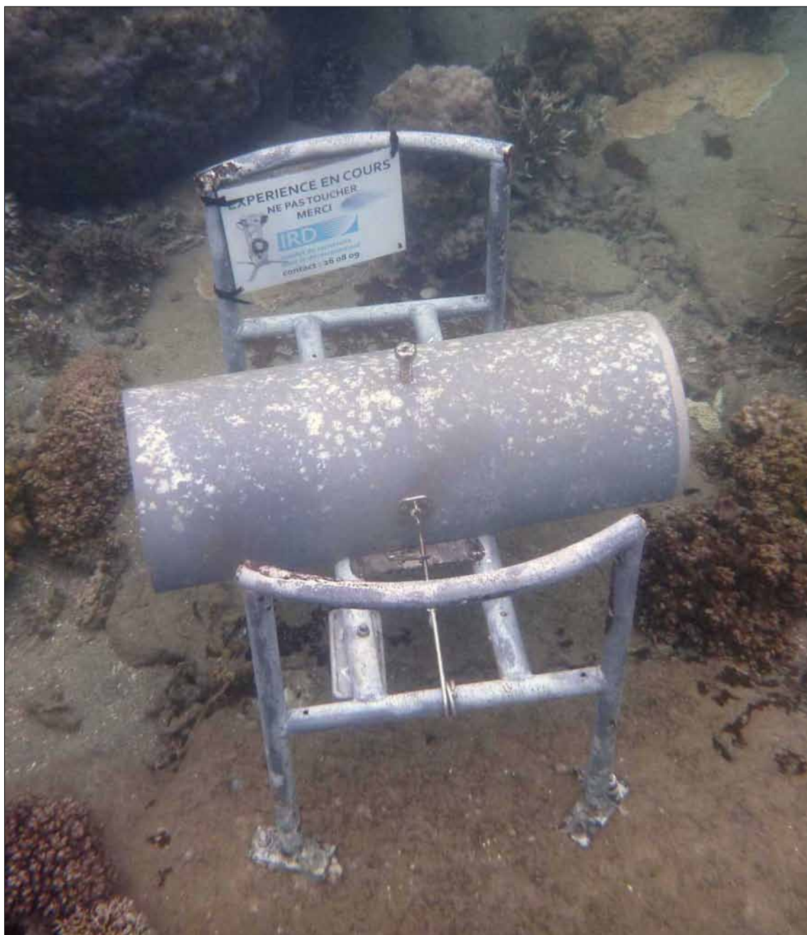
La sonde multi-paramètres fixée à l'île aux Canards qui a permis un suivi en continu de la température, la salinité, la turbidité et la fluorescence. Crédit photo : A. Tribollet
