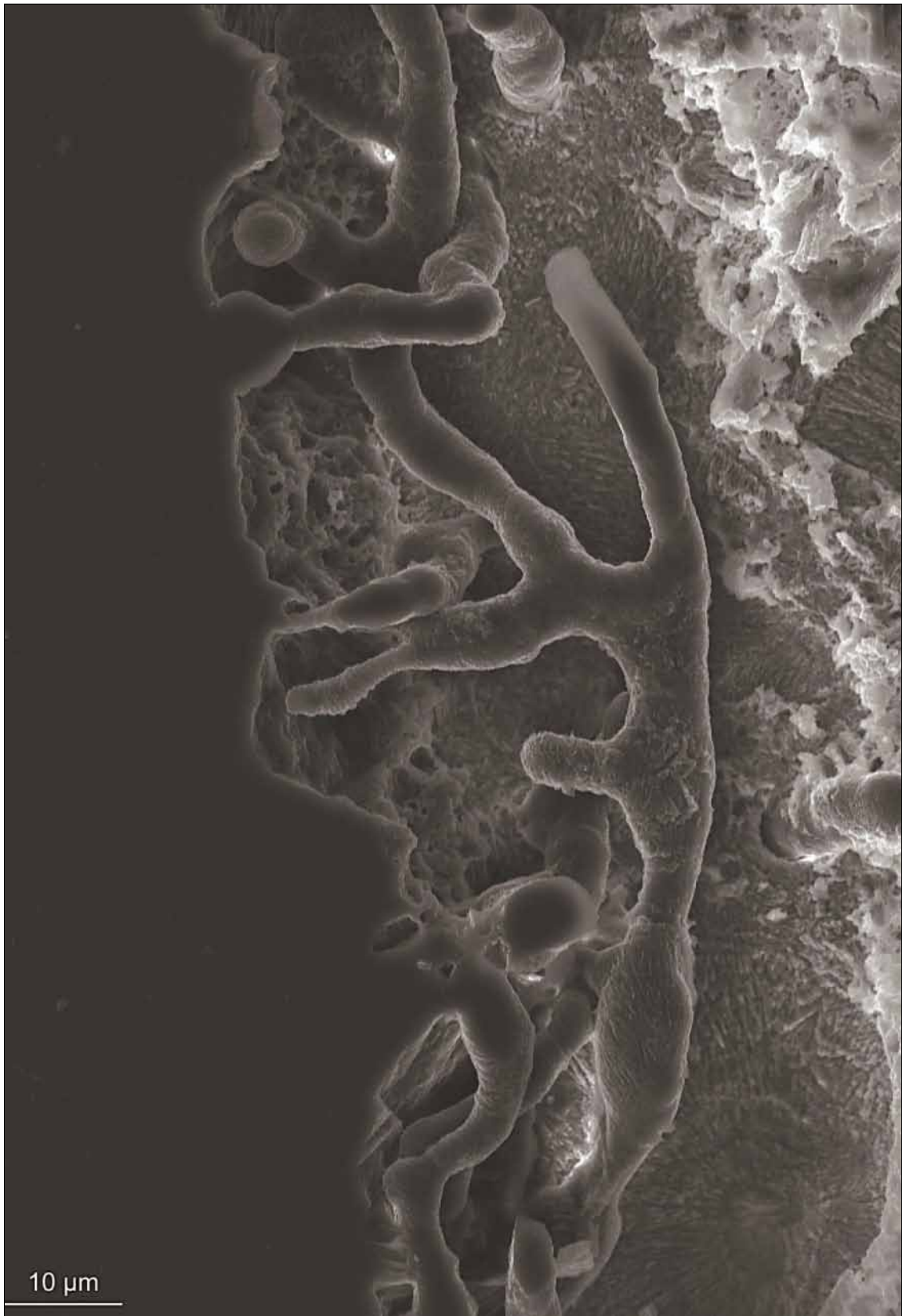
Imprégnation de galeries de microperforants en résine sur une lame mince légèrement décalcifiée, observée au Microscope Electronique à Balayage. Crédit photo : J. Grange.
