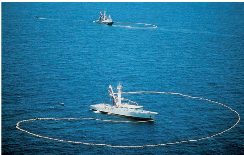
Senneurs remontant leur senne : une opération relativement lente et délicate, qui peut durer d'un peu moins de deux heures (pour un coup nul) à plusieurs heures, selon le volume de la capture. L'efficacité fortement accrue des senneurs depuis vingt-cinq ans a beaucoup réduit la durée de cette opération et permis une hausse marquée des prises par coup de senne.
