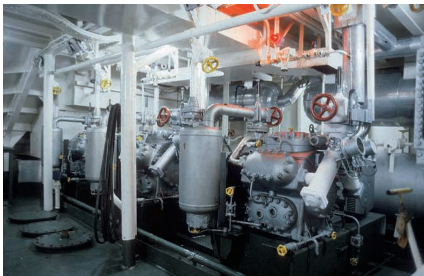
Les compresseurs du senneur Yves de Kerguelen : une usine à froid qui est nécessaire pour maintenir à -18 °C les 1 000 tonnes de thons transportées par ce bateau.
