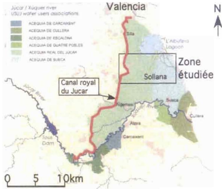
Figure 7.4. Carte des systèmes d'irrigation du Júcar au sud de Valencia (d'après Sánchez). Parmi les canaux prenant l'eau du fleuve Júcar, l'Acequia Real est le plus important. Il délivre de l'eau aux jardins arborés (Huertas) sur 35 km jusqu'aux portes de Valence. L'Acequia de Sueca alimente surtout les rizières dans les basses terres, qui récupèrent aussi les eaux des huertas. Source : USU, projet ISHMM, 2005.
