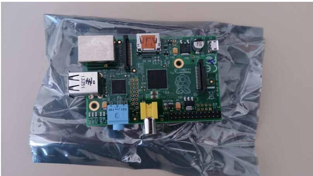
FIGURE 1.37 – *RaspberryPi* utilisé comme noeud dans le montage de certains clusters Framboisine.
