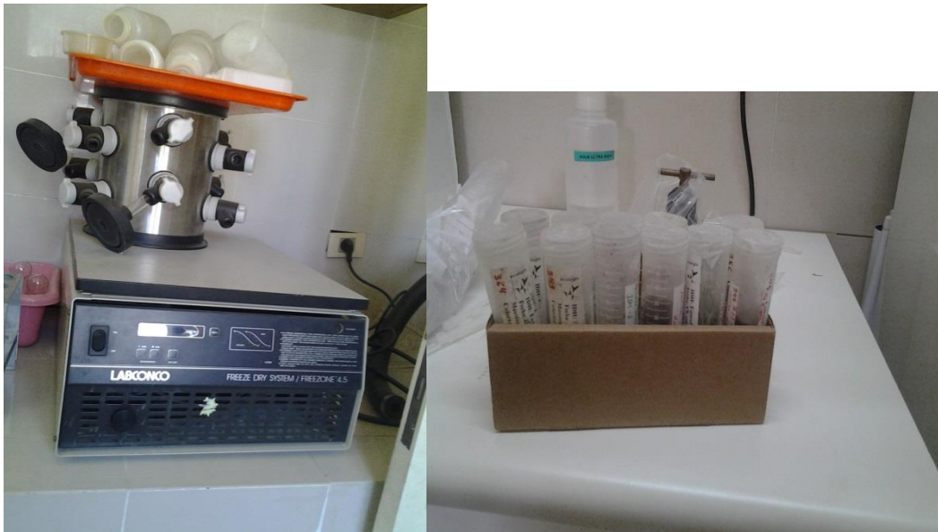
Imagen 5. Liofilizador y muestras en tubos polipropileno con parafilm para ser liofilizadas
