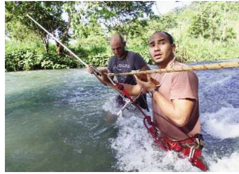
Photographie 10 : Jaugeage des sources du Rio Negro (Rioja, San Martín) au moulinet (15 m 3 /s). Il n'est pas inutile de s'accrocher, car ça pousse fort.
