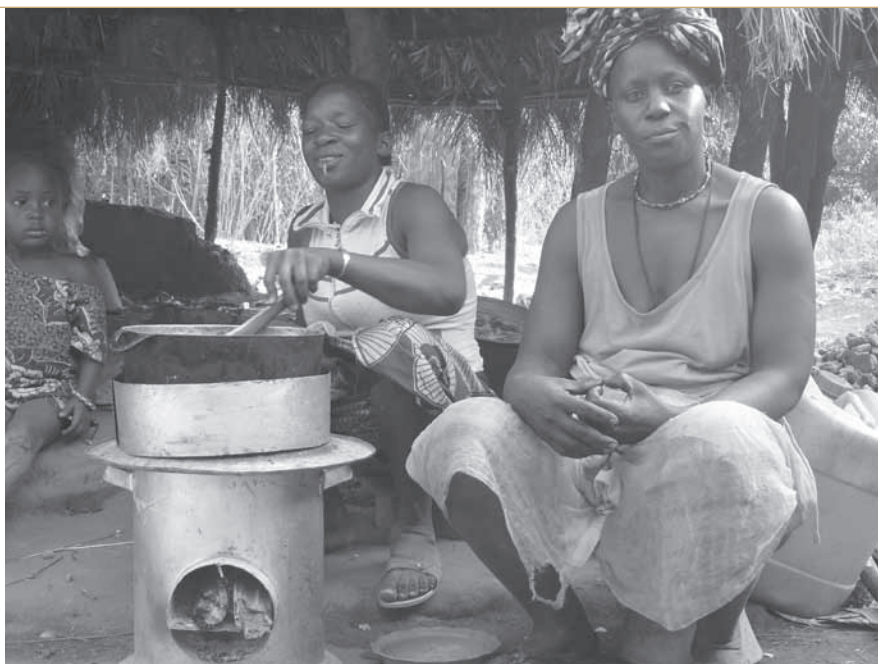
Photo 3 GUINÉE: Le cuiseur à bois économe type «rocket stove» est un foyer de cuisson performant, composé d'une chambre de combustion coudée, d'une enveloppe assurant l'isolation extérieure, d'une grille pour poser le bois facilitant la circulation de l'air. Pour mesurer l'efficacité des cuiseurs, trois protocoles de tests différents sont utilisés et reconnus par APROVECHO, (Centre américain pour le développement et la diffusion de cuiseurs écologiques). Ces tests mesurent la consommation de bois, le temps mis pour atteindre l'ébullition, le calcul du rendement et de la puissance, attestant ainsi d'une réduction de la consommation de bois de plus de 50%.
