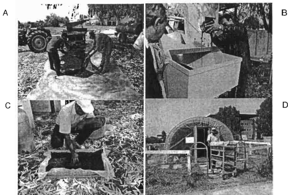
Figure 4: Enrichissement des grignons d'olive par Fermentation en Milieu Solide (FMS). Préparation du substrat (A) ; Inoculation avec une suspension de spores de champignons filamenteux (B) ; Répartition du substrat inoculé sur des plateaux (C) et Transport des plateaux dans le fermenteur pilote (D).
