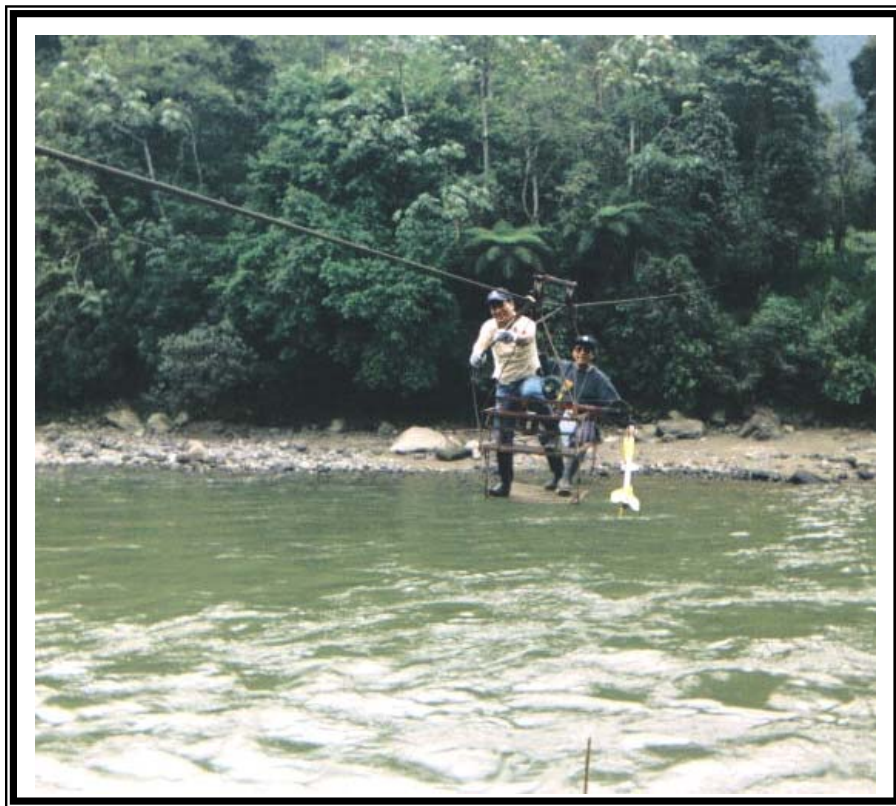
Foto 4: Aforo con Molinete Estación Quijos DJ Oyacachi.
