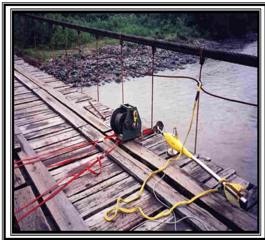
Foto 5: Aforo con molinete desde un puente.
