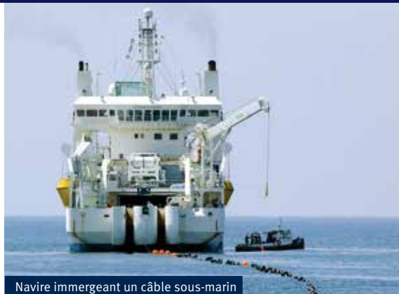
Navire immergeant un câble sous-marin
