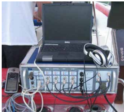
Figure 2-15 : Système de suivi actif utilisé lors des déplacements de dorades coryphènes. Il se compose de quatre hydrophones fixés sur une paravane tractée par le bateau et d'un récepteur (Vemco VR28). Les localisations du bateau sont mesurées à l'aide d'un GPS relié au récepteur. Un ordinateur enregistre les données en temps réel (source : C. Girard).
