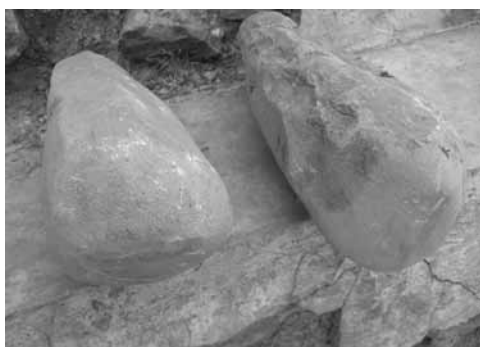
Ph. 2 : Marteaux de la catégorie dikpatikaal ( ditaŋkpakpatikaal ou ntambeenkpatikaal ) pour « étirer » le fer. Tout marteau de cette catégorie porte également le nom de dibɔɔkaal (« celui avec lequel on "joue" »), ou encore ditaŋkpabɔɔkaal (dont la version dans la série des itambeen donne : ntambeembɔɔkaal ).
