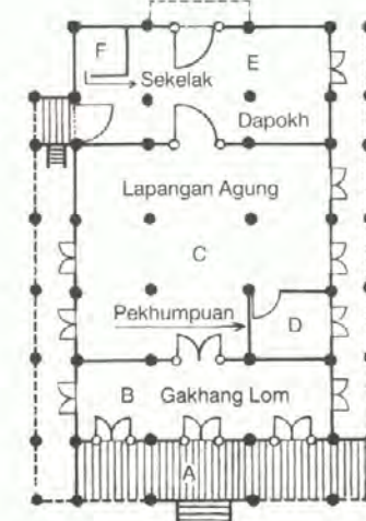
Maison Lampung pesisir sur pilotis du début du XX e s Lampung Pesisir house build on piles at the beginning of the 20 th c Rumah panggung orang Lampung Pesisir dibangun pada awal abad ke 20
