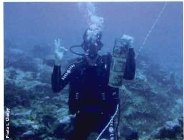
Figure 26 : installation par un plongeur de marégraphe à pression.
