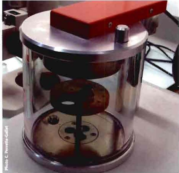
Figure 71 : métalliseur / metal coater.
