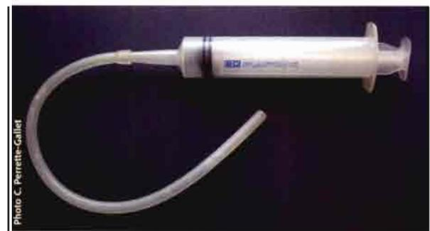
Figure 69 : seringue équipée d'un tuyau souple pour les prélèvements dans les anfractuosités de roche ou de corail.
