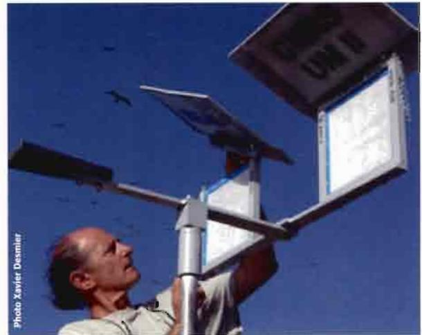
Figure 318 : installation utilisée à Clipperton pour la capture du pollen. Un filtre est exposé durant deux semaines (filtres A). Durant cet intervalle de temps, deux filtres sont successivement exposés chaque semaine (filtres B) fournissant ainsi la série AxB1, AxB2 pour une quinzaine déterminée.
