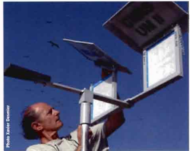
Figure 318 : installation utilisée à Clipperton pour la capture du pollen. Un filtre est exposé durant deux semaines (filtres A). Durant cet intervalle de temps, deux filtres sont successivement exposés chaque semaine (filtres B) fournissant ainsi la série AxB1, AxB2 pour une quinzaine déterminée. Device used to collect pollen at Clipperton. A filter is exposed for two weeks (filters A). During this interval, two filters are successively exposed each week (filters B) providing the series AxB1, AxB2 for a determined fortnight.
