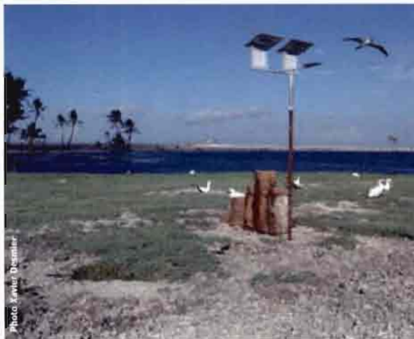
Figure 318 : installation utilisée à Clipperton pour la capture du pollen. Un filtre est exposé durant deux semaines (filtres A). Durant cet intervalle de temps, deux filtres sont successivement exposés chaque semaine (filtres B) fournissant ainsi la série AxB1, AxB2 pour une quinzaine déterminée. Device used to collect pollen at Clipperton. A filter is exposed for two weeks (filters A). During this interval, two filters are successively exposed each week (filters B) providing the series AxB1, AxB2 for a determined fortnight.
