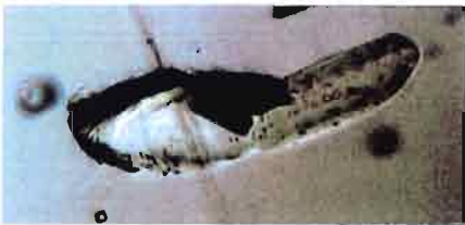
Fig. 31 - Cristal d'albite (160 μm) avec des inclusions montrant des couleurs d'interférence du premier ordre (orange) Diascopie, lumière polarisée (⊗), 400x. Photo Gemteclab.
