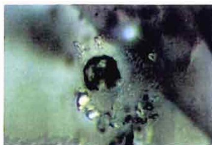
Fig. 27 - Certaines cavités sont entourées de cristaux d'albite, d'apparence partiellement dissous, formant des domaines turbides. Diascopie, lumière polarisée (⊗), 30x. Photo Gemtechlab. Some cavities are surrounded by albite crystals of partially dissolved appearance, creating a turbid field. Diascopy, polarized light (⊗), 30x.
