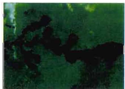
Fig. 26 - Inclusion dendritique. Diascopie, 50x. Photo Gemtechlab. Dendritic inclusion. Diascopy, 50x.
