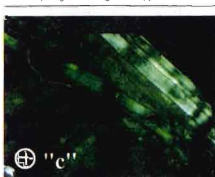
Fig. 15 - Certains cristaux pas ou peu transparents présentent à leur périphérie et parallèlement aux faces du prisme des couches gemmes, souvent multiples, montrant des alternances de teinte et/ou d'intensité de couleur. Sur ce cliché, le groupe de couches externes (à droite) ne présente pas tout à fait la même orientation que la précédente dont elle est séparée par une zone non gemme. Diascopie, lumière polarisée (//), 20x. Photo Gemtechlab.
