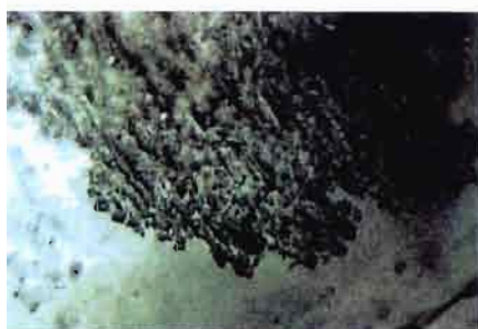
Fig 28 - Petits cristaux d'albite formant un voile. Diascopie, lumière polarisée (//), 400x. Photo Gemtechlab. Small albite crystals forming a veil. Diascopy, polarized light (//), 400x.
