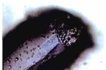
Fig. 36 - Extrémité du cristal d'actinolite montrant des reliefs tétraédriques formés de faces {011} et {110}. Diascopie, lumière polarisée (⊗), 400x. Photo Gemteclab.
