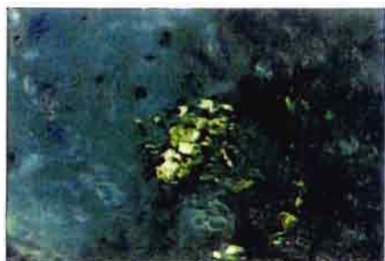
Fig 25 - Inclusion de pyrrhotite de morphologie feuilletée. Episcopie, 50x. Photo Gemtechlab Foliated pyrrhotite inclusions. Episcopy, 50x
