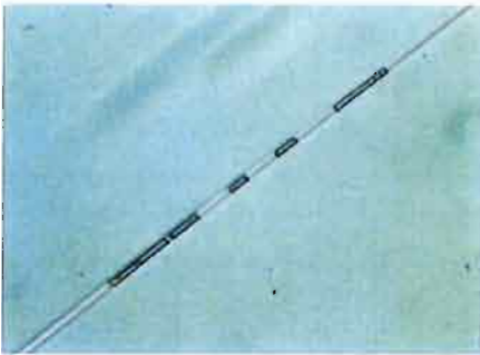
Fig 21 - Inclusion multiphase à séquences complexes dans un canal, dans l'ordre, de gauche à droite: H 2 O - trois solides - CO 2 liquide - CO 2 gazeux - CO 2 liquide - H 2 O - deux solides - CO 2 gazeux - H 2 O - CO 2 liquide - H 2 O - CO 2 liquide - CO 2 gazeux - CO 2 liquide - H 2 O. Diamètre du canal: Ø 6 µm. Diascopie, lumière polarisée (//), 400x. Photo Gemtechlab.
