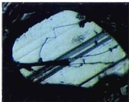
Fig. 16 - Empreinte d'un cristal de phlogopite à la surface d'une émeraude de Piteiras. Lumière réfléchie. 120x. Photo Gemtechlab. Cast of a phlogopite crystal on the surface of a Piteiras emerald. Reflected light, 120x.
