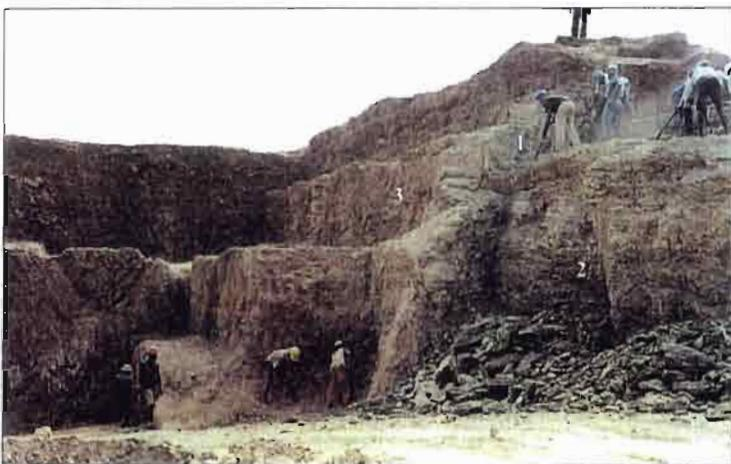
Zone de contact à rubis (1) séparant les gneiss à sillimanite (2) des roches mafiques de couleur rougeâtre (3) dans le Kimbo Pit
