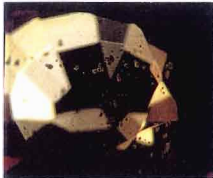
Figure 10 : Inclusions en "mie de pain" correspondant à des petits cristaux totalement fondus par les très hautes températures utilisées. Grossissement 8x. Micrographie E. Fritsch.
