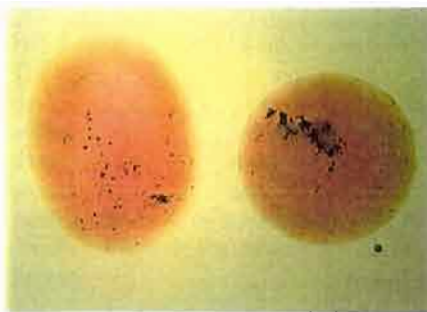
Figure 2 : Les saphirs de la fig 1 vus en immersion dans le diiodométhane, montrent une zonation, de couleur orange vers l'extérieur et rose au cœur, assez régulière. Grossissement 3x. Micrographie E. Fritsch.
