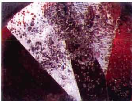
Figure 11 bis : Sévère altération de la surface d'un saphir non repoli après le traitement au béryllium. 50x. Micrographie F. Notari.
