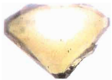
Figure 3: Tranche montrant un cœur rose et une périphérie orange, étudiée par absorption UV-Visible et analyse ICPMS-LA. On distingue des soies en pointillé et un "minivolcan" soulevant une écaille sur la face du pavillon à droite. Grossissement 14x. Micrographie E. Fritsch.
