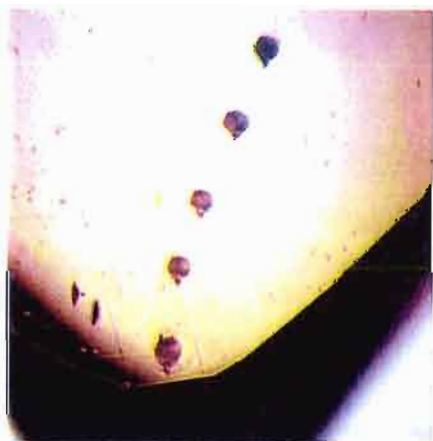
Figure 13 : Détail du premier profil ICPMS-LA allant de la cutase orange au cœur rose du saphir. On note la taille des trous creusés par le laser. Micrographie B. Devouard.
