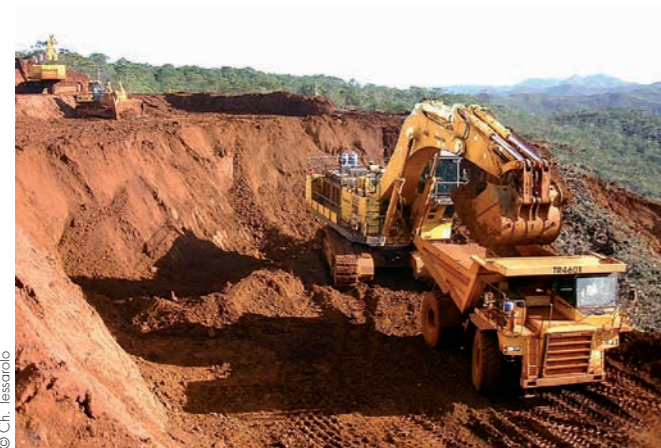
Le chargement d'un camion de 105 t à destination de l'usine de préparation du minerai
