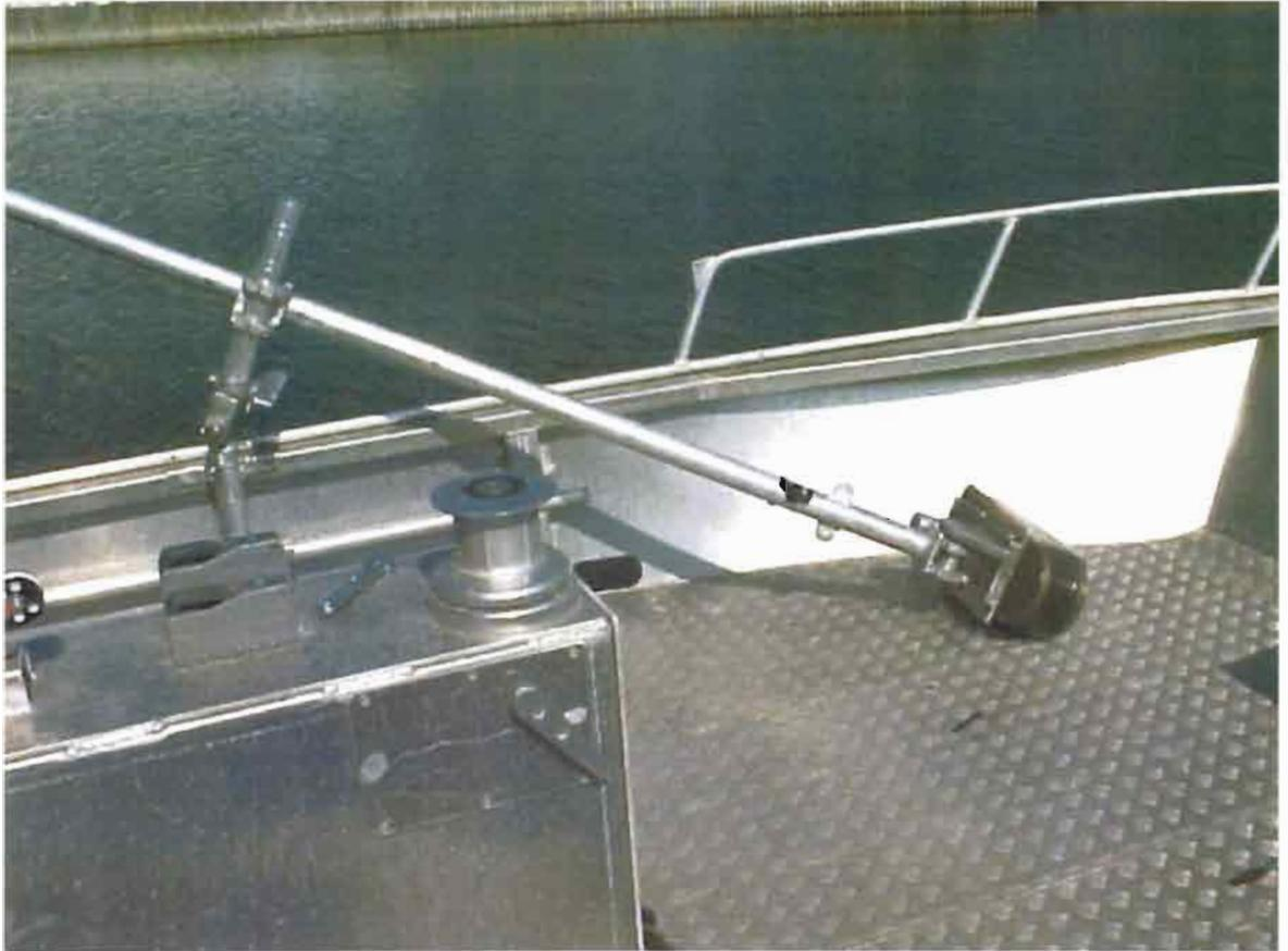
**Figure 4 :** Bras articulé soutenant la base du sonar multifaisceaux.
