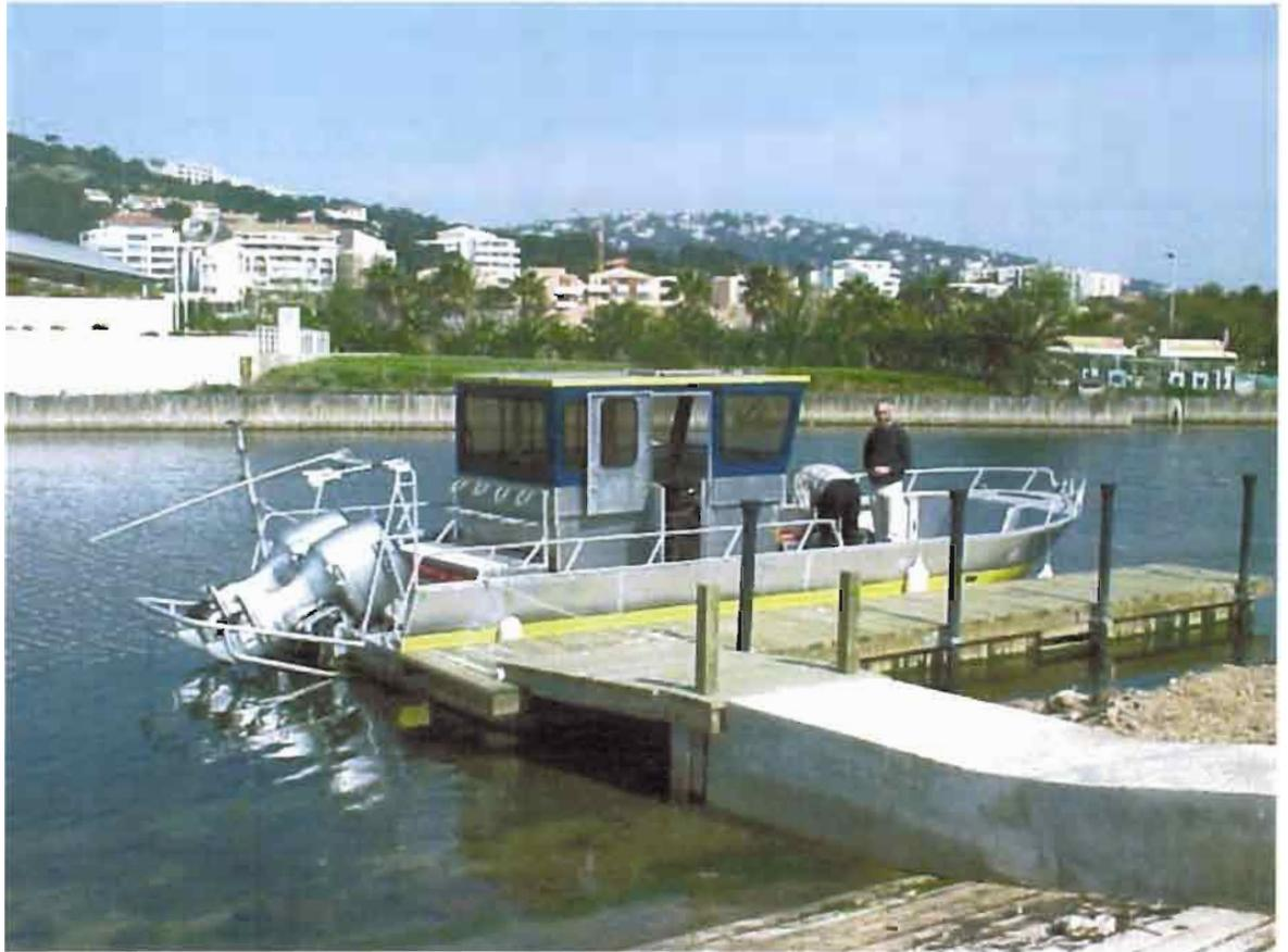
**Figure 3 :** Le Chlamys (2\*115CV, 7m) à quai au centre RHMT de Sète, à bord B. Liorzou et Y. Guénégan pour l'installation du « PC scientifique » et du tube articulé conçu pour fixer le transducteur du sonar de chez Reson.
