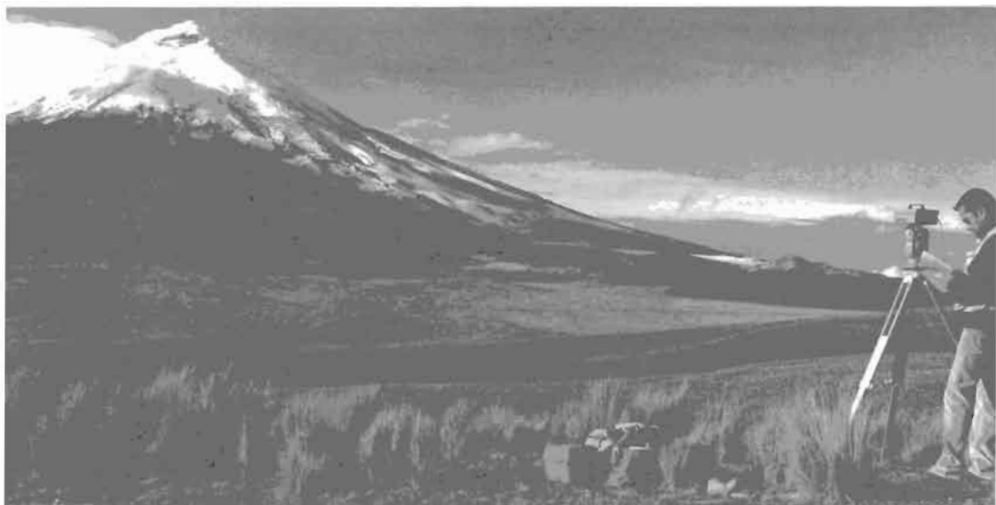
Figura 26. Mediciones de EDM realizadas desde la base BOSQ (ver también Fig. 24). El EDM es un instrumento que mide con gran precisión la distancia entre dos puntos fijos mediante un emisor y un reflector de rayos láser. (Foto: P. Mothes).
