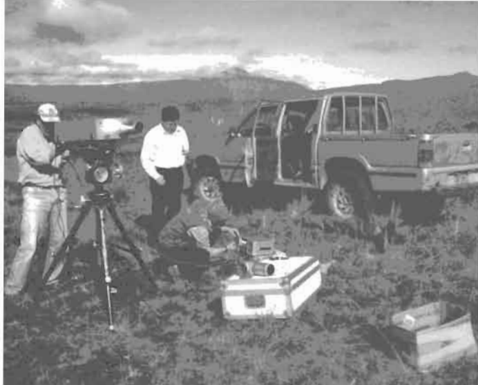
Figura 29. El sensor remoto COSPEC (espectrómetro de correlación, por sus siglas en inglés) mide a distancia el contenido de gases magmáticos en las emisiones volcánicas. Un alto contenido de gases magmáticos (p.e. SO_2 ) puede significar que un período de actividad volcánica se aproxima. Izquierda: medidas realizadas en el Cotopaxi. Derecha: medidas realizadas en el Tungurahua. (Fotos: P. Mothes y D. Andrade).
