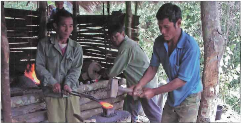
Façonnage d'une lame de machette à la forge communautaire (Tongpi, 12/2003).
