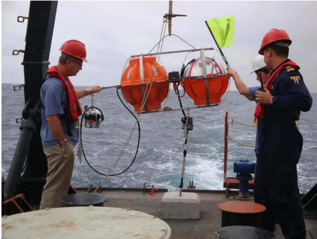
Mise en place du réseau de sismomètres en mer. IRD, Author provided
