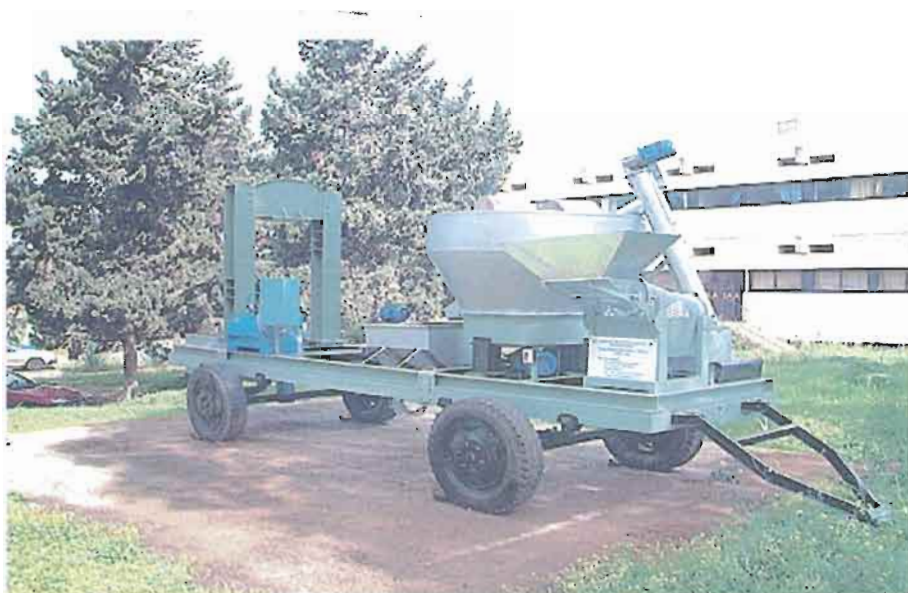
Figure 4. Unité mobile de trituration d'olives (Objet d'un brevet d'invention)
