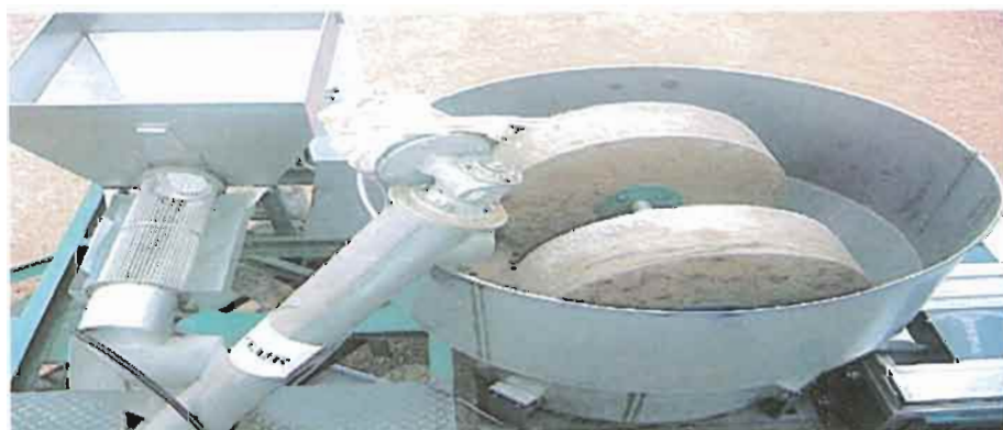
Figure 8. Système de broyage (meules en granit)
