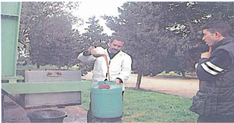
Figure 13. Récupération des huiles d'olives décantées à partir du bassin de décantation
