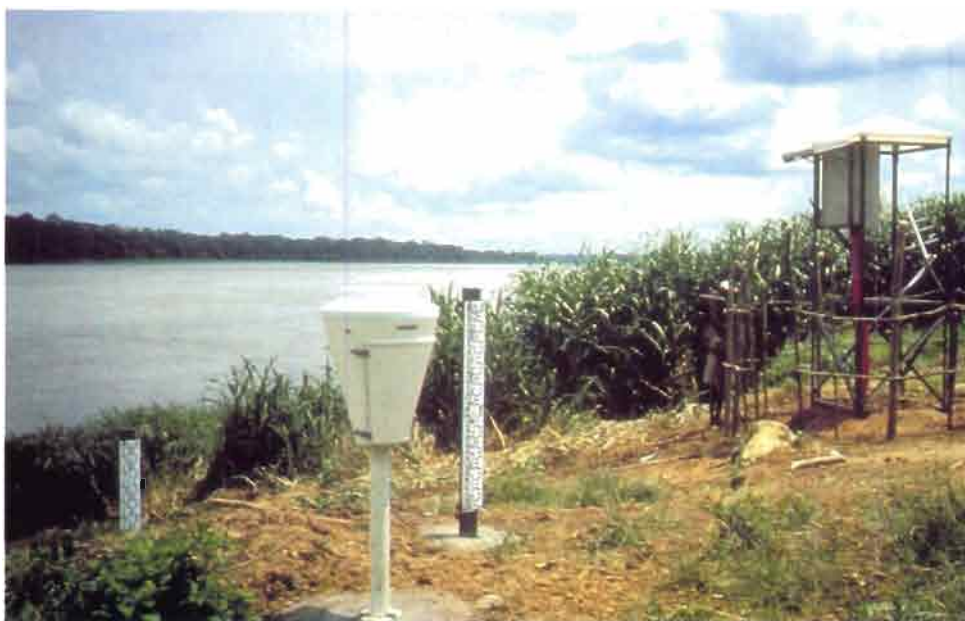
Station hydro-pluviométrique de Limassa sur le fleuve Oubangui (Centrafrique)
